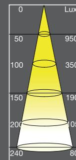
In **Lux** hingegen wird die Beleuchtungsstärke angegeben, die auf eine **Fläche** auftrifft (Helligkeit)
